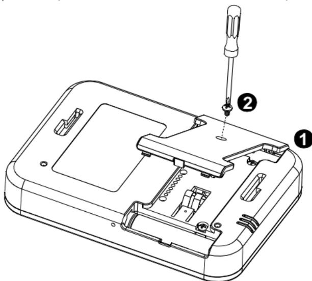
*Figure 2 - montage du couvercle de pile (partie a)*
