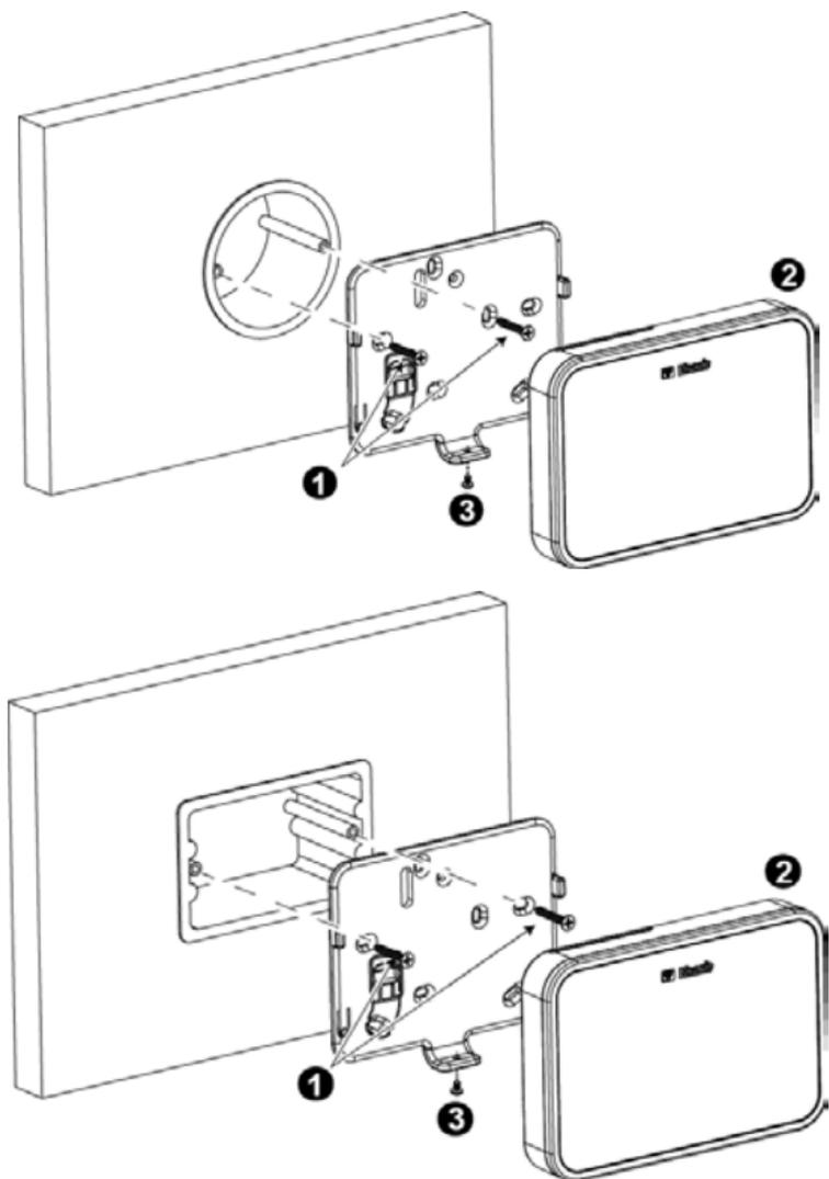
Figure 4b – installation murale avec prise électrique externe
