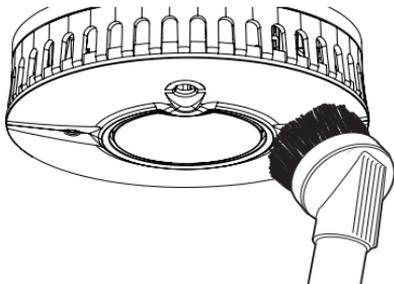
**AVERTISSEMENT :** Votre détecteur de fumée AngelEye™ peut déclencher une alarme indésirable pendant le nettoyage à l'aide d'un aspirateur.
